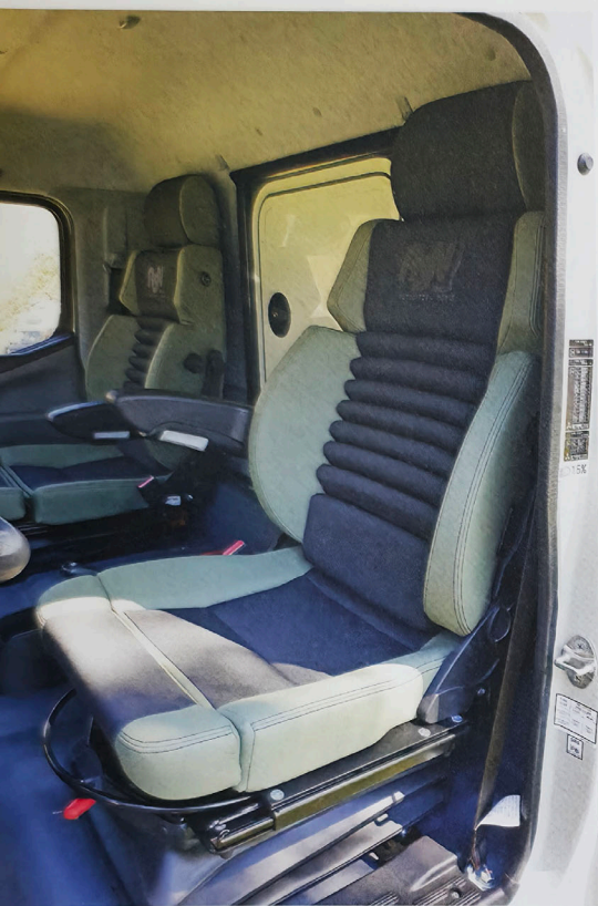
Insbesondere bei hohen Fahrzeugen erleichtert eine tiefe Sitzkante das Einsteigen, die ausziehbare Sitzfläche die Anpassung an Fahrer und Fahrerin.
