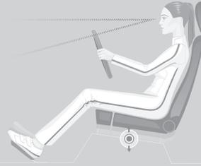
**4.** Die Sitzflächenneigung so ausrichten, dass die Pedale leicht durchgetreten werden können. Die Oberschenkel sollen leicht aufliegen, ohne Druck auf das Sitzkissen. Überprüfen Sie vor dem Start die Rückenlehnenneigung.
