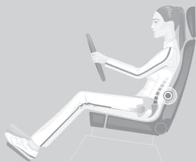
**7.** Die Seitenführungen des Sitzes sollten so nah am Körper liegen, dass der Oberkörper ohne Beugung angenehm seitlich unterstützt wird.
