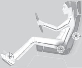
**2.** Die Schultern so dicht wie möglich an die Sitzlehne rücken. Die Rückenlehnenneigung so ausrichten, dass das Lenkrad mit leicht angewinkelten Armen gut erreicht wird. Beim Drehen des Lenkrads muss der Schulterkontakt erhalten bleiben.
